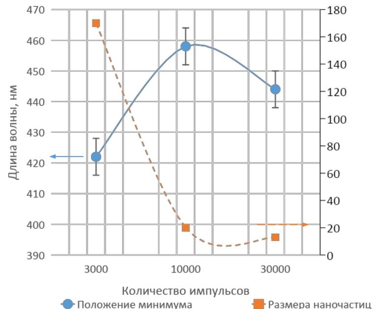
Зависимость положения минимума спектра пропускания и размера наночастиц от количества импульсов
