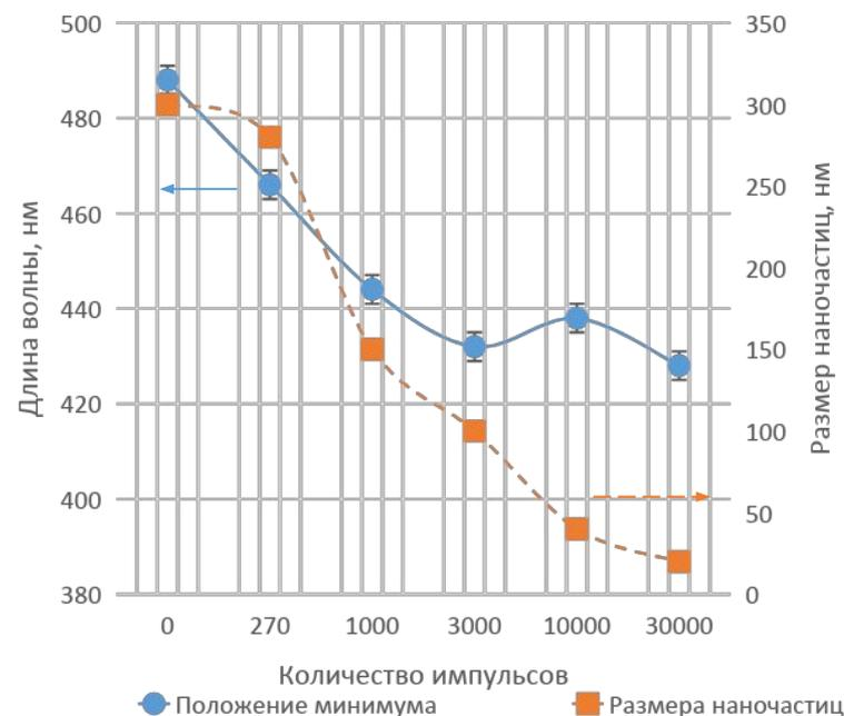
Зависимость положения минимума спектра пропускания и размера наночастиц от количества импульсов
