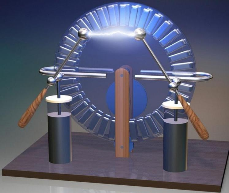
Называется этот прибор электрофорная машина. Плюс ее в том, что мы получаем сразу высокое напряжение. Однако сила тока весьма ничтожна, и кроме эффектной демонстрации искровых разрядов такие приборы ни на что не годятся.
