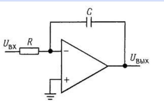
Рис. 1. Интегратор на основе операционного усилителя
