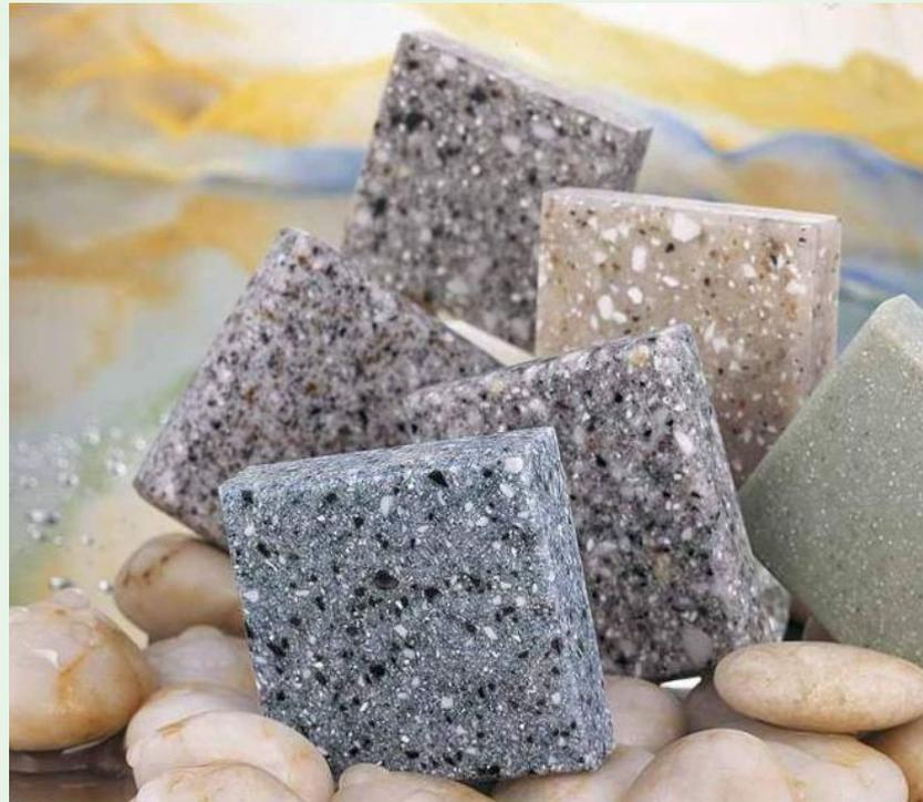
Рисунок 1-Образцы полимербетона.
