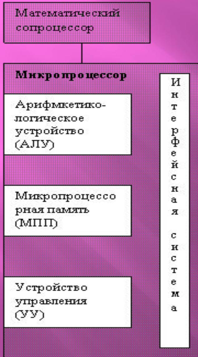
Микропроцессор – это устройство, выполняющее обработку информации на персональных компьютерах, управляет вычислительным процессом, арифметическими и логическими операциями.
