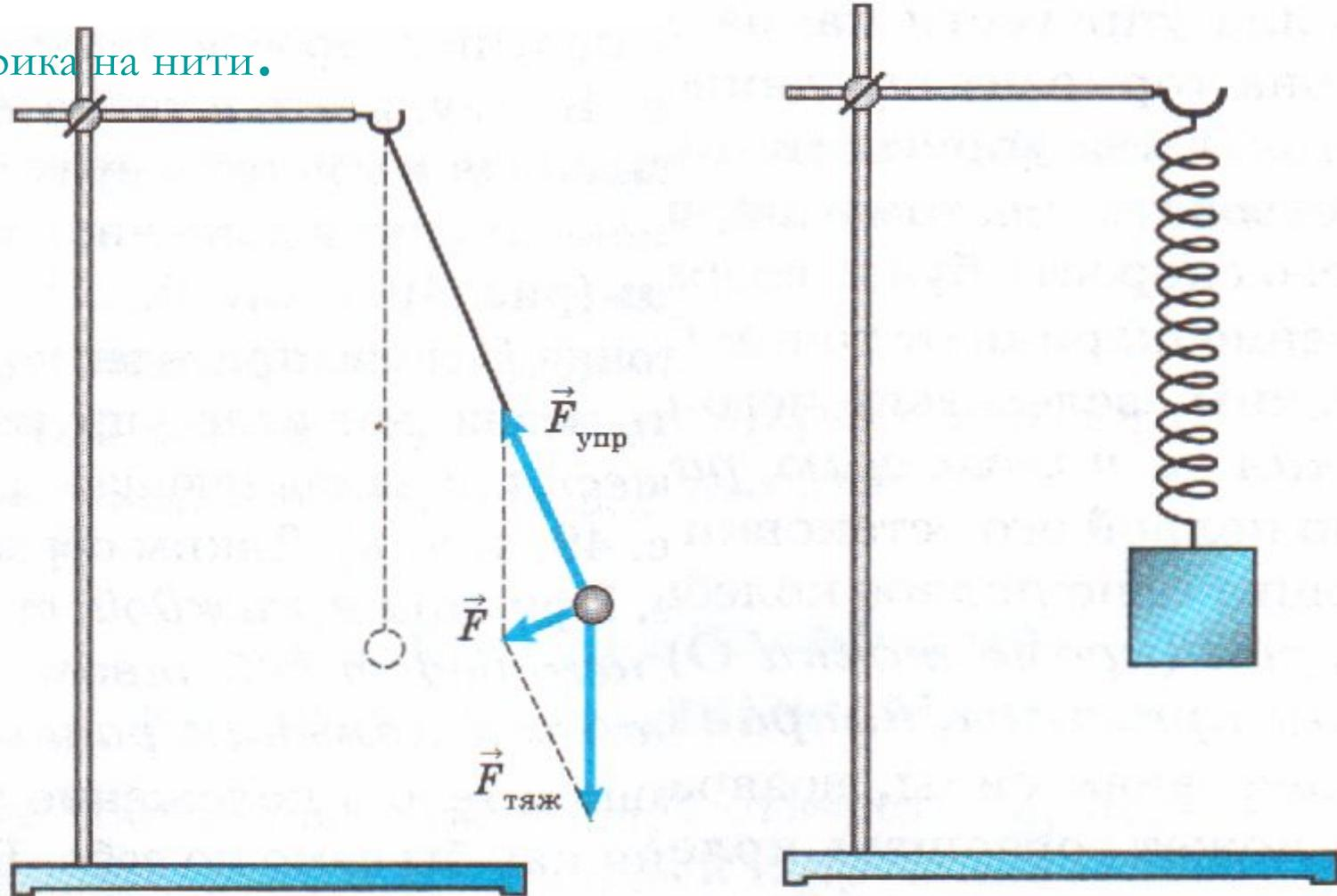
В данном случае шарик совершает свободные колебания под действием двух сил: силы тяжести и силы упругости нити. Их равнодействующая направлена к положению равновесия.
