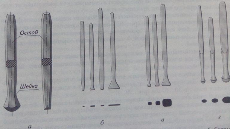
Рис. 96. Чеканы: а – конструкция; б – расходники; в – лощатники; г – бобошники
