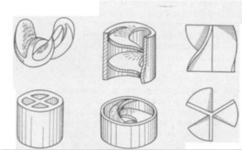
*Фасонную насадку* выполняют в виде керамических седел, цилиндров с перегородками, пропеллеров и т.д., загружаемых в аппарат навалом.
