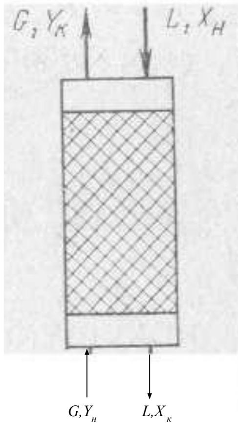
**Противоточная схема.** По этой схеме в одном конце аппарата приводятся в контакт газ и жидкость, имеющие большие концентрации распределенного вещества, а в противоположном конце – меньшие.
