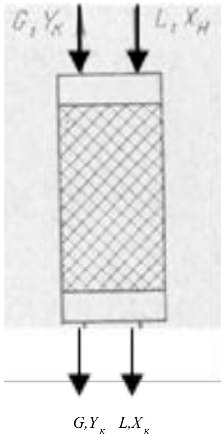
В **прямоточной** схеме потоки газа и абсорбента движутся параллельно друг другу; при этом газ с большей концентрацией распределяемого вещества приводится в контакт с жидкостью, имеющей меньшую концентрацию распределяемого вещества, а газ с меньшей концентрацией взаимодействует на выходе из аппарата с жидкостью, имеющей большую концентрацию распределяемого вещества.
