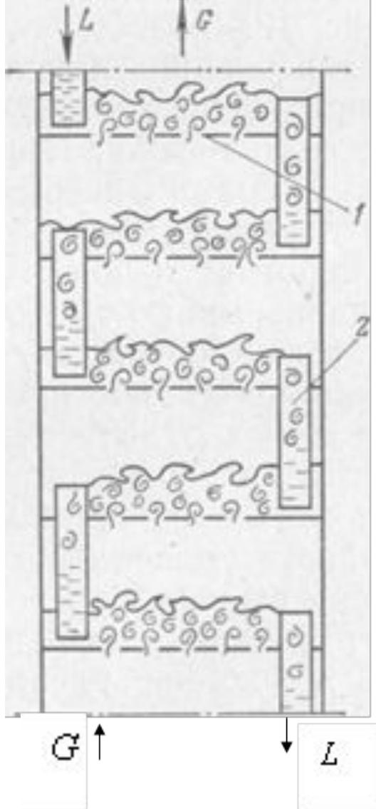
Тарельчатые колонны с переливными устройствами снабжены горизонтальными тарелками **1** и переливными устройствами **2**. Жидкость **L** поступает на верхнюю тарелку, переливается через переливные устройства сверху вниз и удаляется из нижней части аппарата. Газ (пар) **G** вводится в нижнюю часть аппарата и перемещается вверх, распределяясь на каждой тарелке в виде пузырьков или факелов. В зависимости от способа распределения газа (пара) на тарелках различают тарелки ситчатые и колпачковые.
