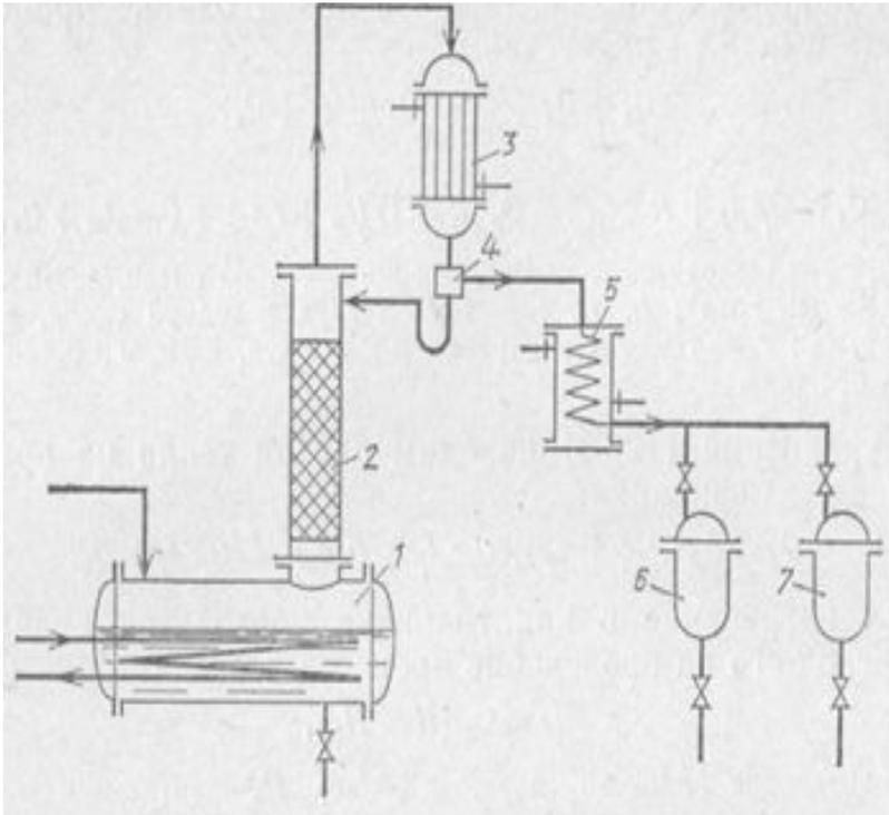
Исходная смесь загружается в куб 1, где нагревается до температуры кипения и испаряется. Пары проходят через ректификационную колонну 2, взаимодействуя в противотоке с жидкостью, возвращаемой из дефлегматора 3. В дефлегматоре 3 богатые легколетучим компонентом пары конденсируются, и конденсат поступает в делитель потока 4. Часть жидкости из делителя потока направляется на орошение ректификационной колонны, а другая часть – дистилят – проходит через холодильник 5 и направляется в сборник 6 или 7.
