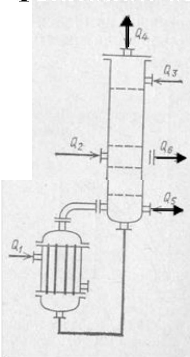
$Q_1$  – тепло, поступающее в кипятильник ректификационного аппарата с греющим паром, кДж/ч;
