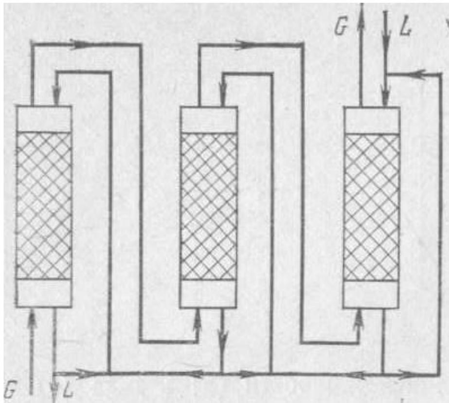
**Многоступенчатые схемы с рециркуляцией** обладают всеми преимуществами одноступенчатых схем и вместе с тем обеспечивают большую движущую силу процесса.
