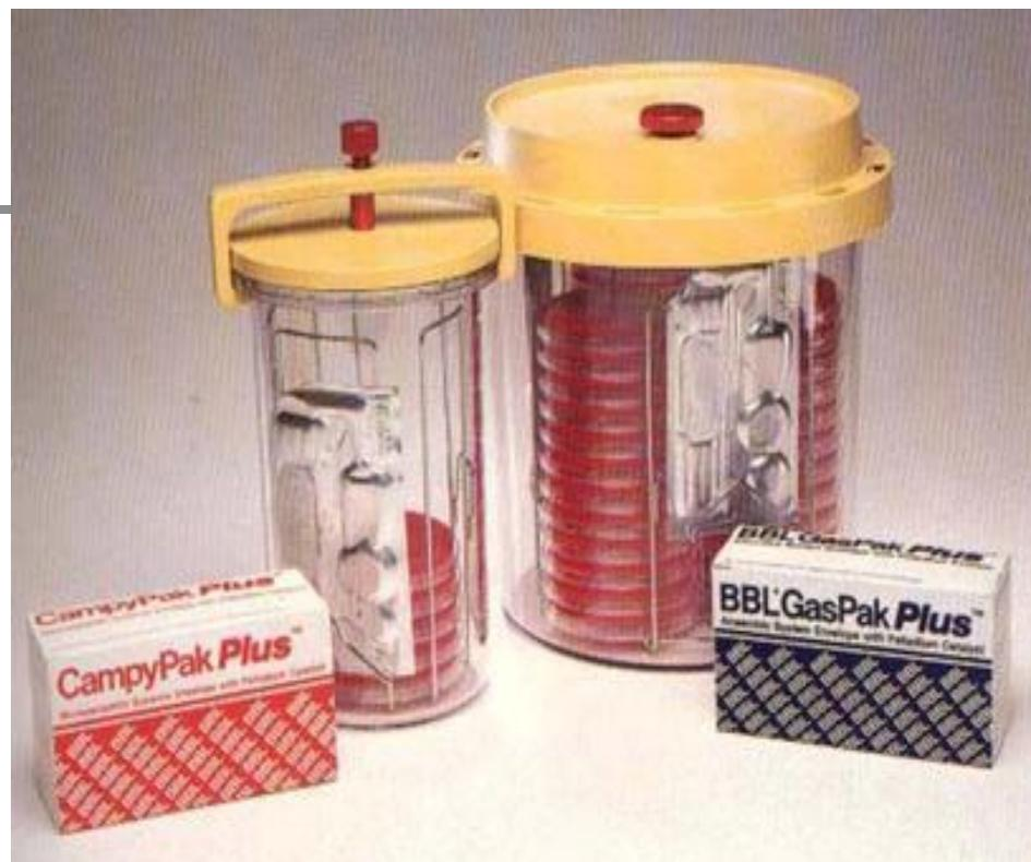
**GasPak** — система химическим путем обеспечивает постоянство газовой смеси приемлемой для роста большинства анаэробных микроорганизмов. В герметичном контейнере, в результате реакции воды с таблетками бикарбоната натрия образуется водород и углекислый газ. Водород затем реагирует с кислородом газовой смеси на катализаторе с образованием воды.
