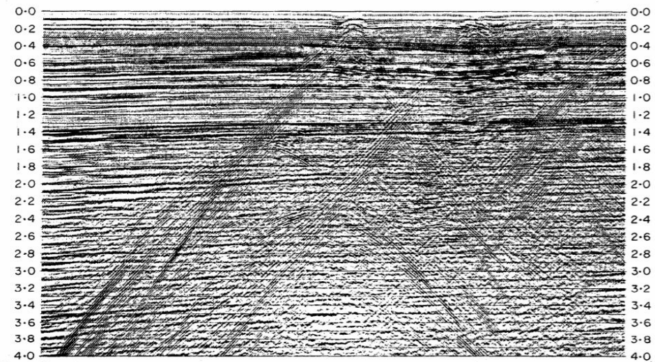
Рис. 3.69. Суммарный разрез с интенсивными регулярными помехами, вызванными рассеянием на приповерхностных неоднородностях.
