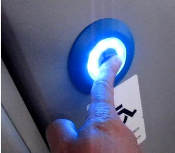
1) Если поезд стоит и дверь разблокирована, то дверь сразу откроется. Кнопка «Инвалид» из подсвеченного состояния перейдет в моргающее состояние. До подачи блокирования дверей данная дверь открыта постоянно. На ИЧМ в строке символов появляется символ «Инвалид». Если от момента нажатия кнопки, до подачи разблокировки дверей из кабины пройдет более 100 секунд, то команда «Инвалид» самосбрасывается.
