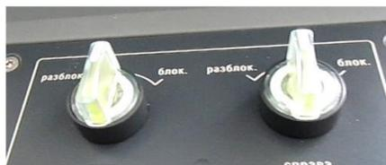
5) Тумблеры управления дверьми подсвечены во время между нажатием пассажира на рычаг до закрытия двери приводом. В это же самое время тяга будет прервана
