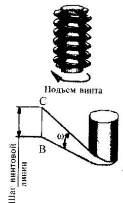
При свинчивании болта и гайки с **правой резьбой** их нужно вращать вправо, т.е. по ходу часовой стрелки.
