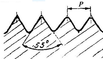
Например, **Резьба 3/8'' -16** - обозначает дюймовую резьбу с наружным диаметром 3/8 дюйма и числом ниток на одном дюйме 16. Шаг этой резьбы равен 1/16''.
