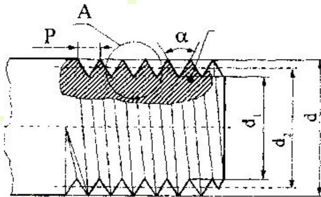
**Профиль резьбы** – вид сечения резьбы в плоскости диаметра.
