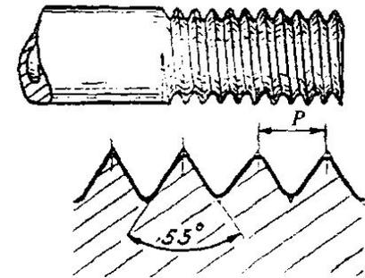
За номинальный диаметр трубной резьбы принимают внутренний диаметр резьбы.
