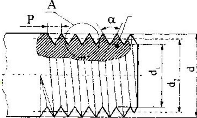
**Наружный диаметр резьбы  $d$**  – диаметр по вершинам резьбы у болтов и по основаниям впадин у гаек.
