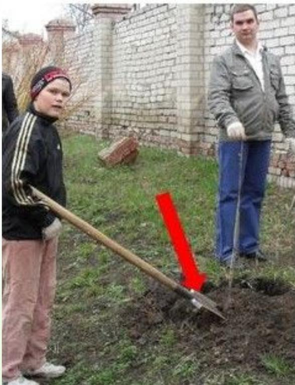
ПЕРЕД НАЧАЛОМ РАБОТЫ ПРОВЕРИТЬ ИСПРАВНОСТЬ РАБОЧЕЙ ЧАСТИ, СОСТОЯНИЕ И НАСАДКУ ЧЕРЕНКА ЛОПАТЫ.
