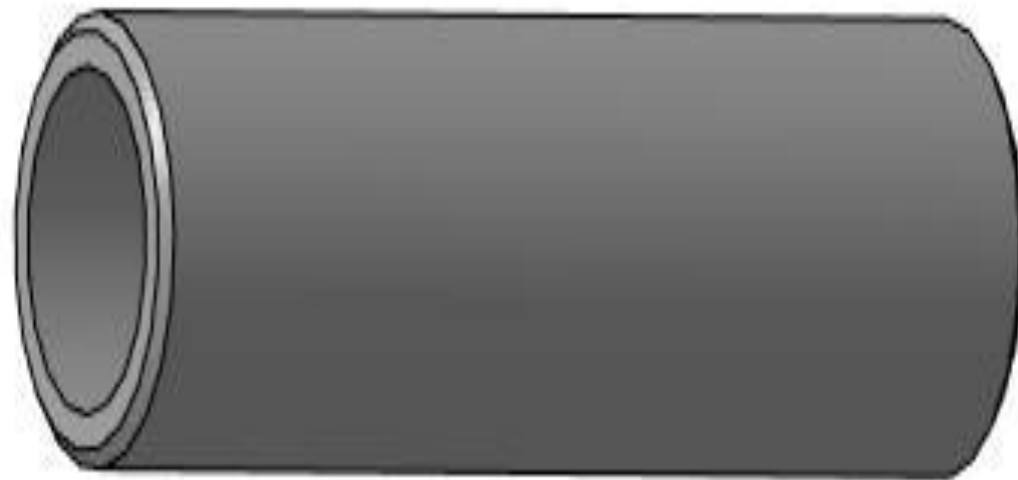
3д модель детали «палец поршневой»
