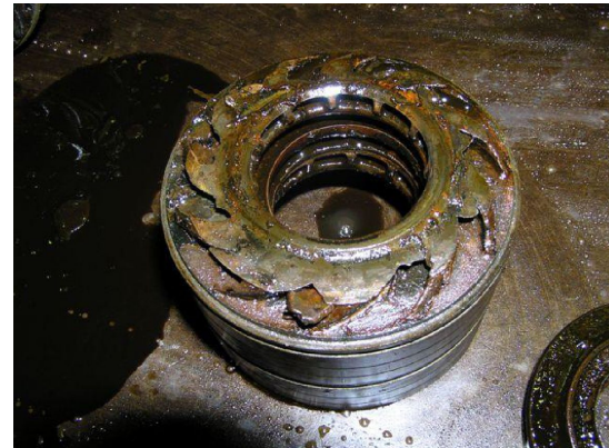
Вынос песка из пласта ПК1 при использовании стандартной схемы заканчивания
