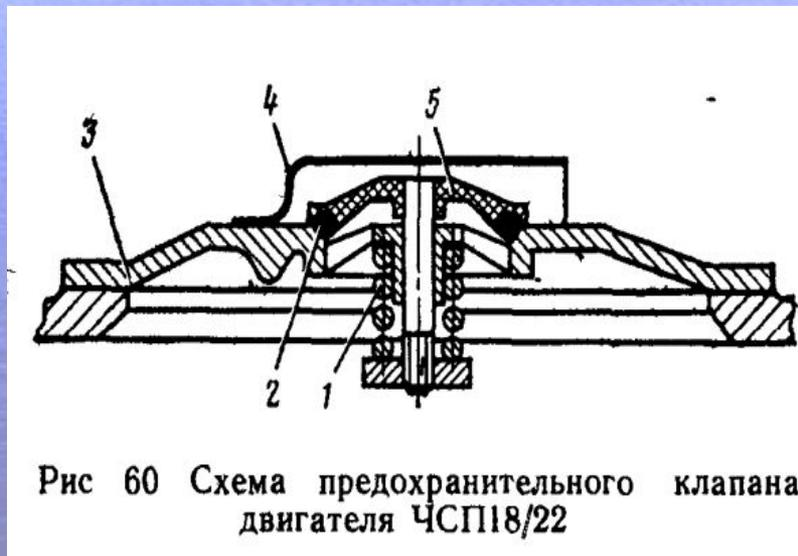
Рис 60 Схема предохранительного клапана двигателя ЧСП18/22
