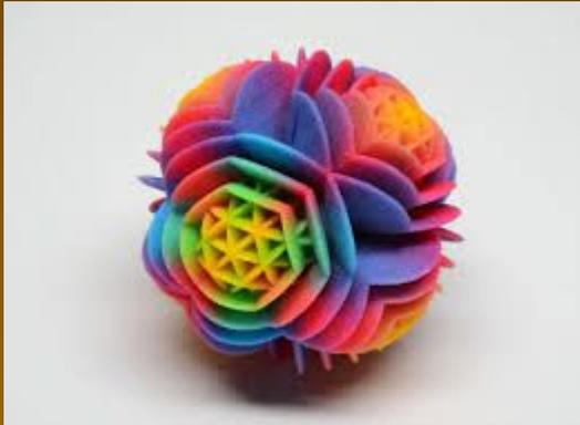
3D-печать может осуществляться разными способами и с использованием различных материалов, но в основе любого из них лежит принцип **послойного создания (выращивания) твёрдого объекта**
