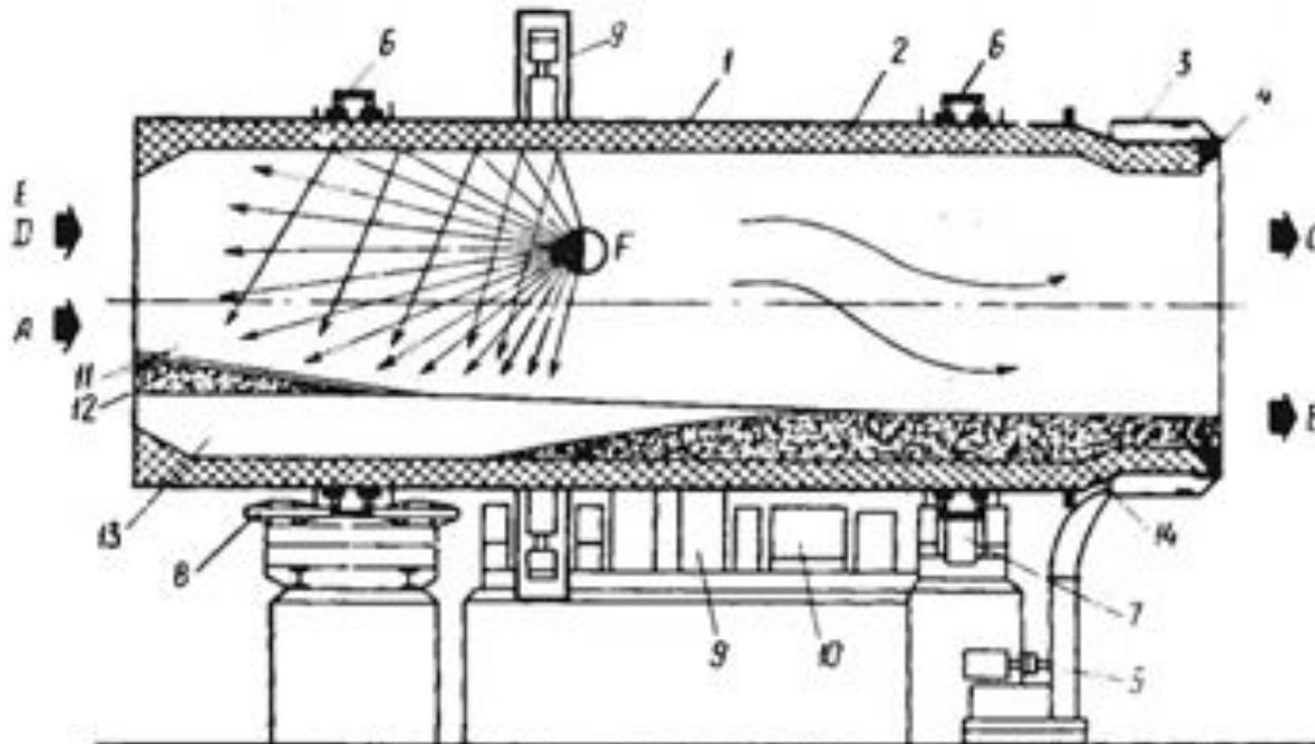
**А – загрузка отходов, В – выгрузка золы, С – дымовые газы, Д – дополнительное топливо, Е – воздух, Г – тепловое излучение;**
