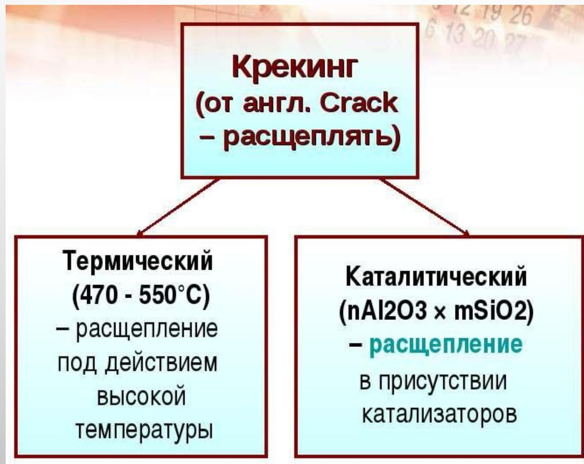
Термические методы переработки нефти и нефтепродуктов имеют радикально-цепной характер. При температурах выше 400 °С начинается гомолиз С-С связей (С-Н связь в алканах более прочная), в первую очередь — связей у третичного атома углерода как наиболее слабых.
