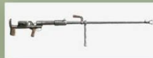
ружьё противотанковое ПТРД-41 Дегтярёв
