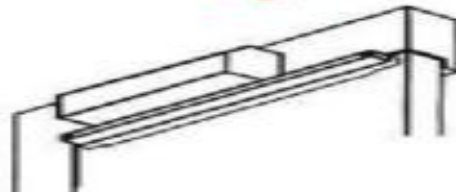
Скользящая тяга монтаж на раме
