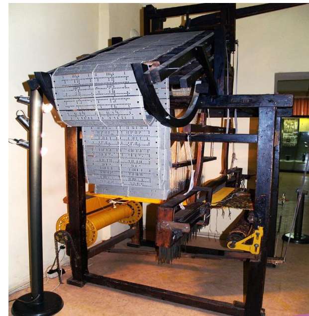
Ткацкий станок с перфолентами. Жозеф Жаккар. 1804 год.
