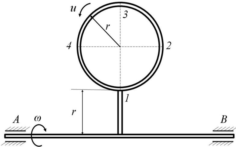
Полое кольцо радиусом  $r$  жестко соединено с валом  $AB$ , и притом так, что ось вала расположена в плоскости кольца. Кольцо заполнено жидкостью, движущейся в направлении стрелки с постоянной относительной скоростью  $u$ .
