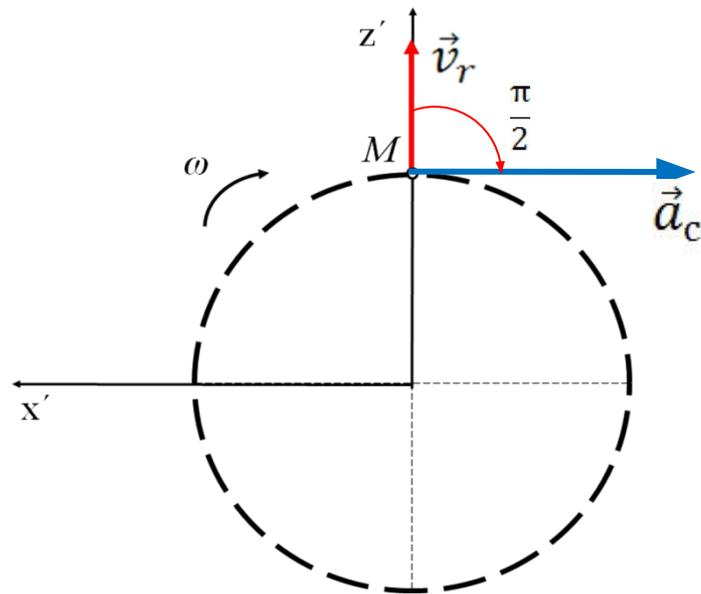
Так как *относительное, переносное ускорения* и *ускорение Кориолиса* взаимно перпендикулярны, то модуль абсолютного ускорения определяется равенством
