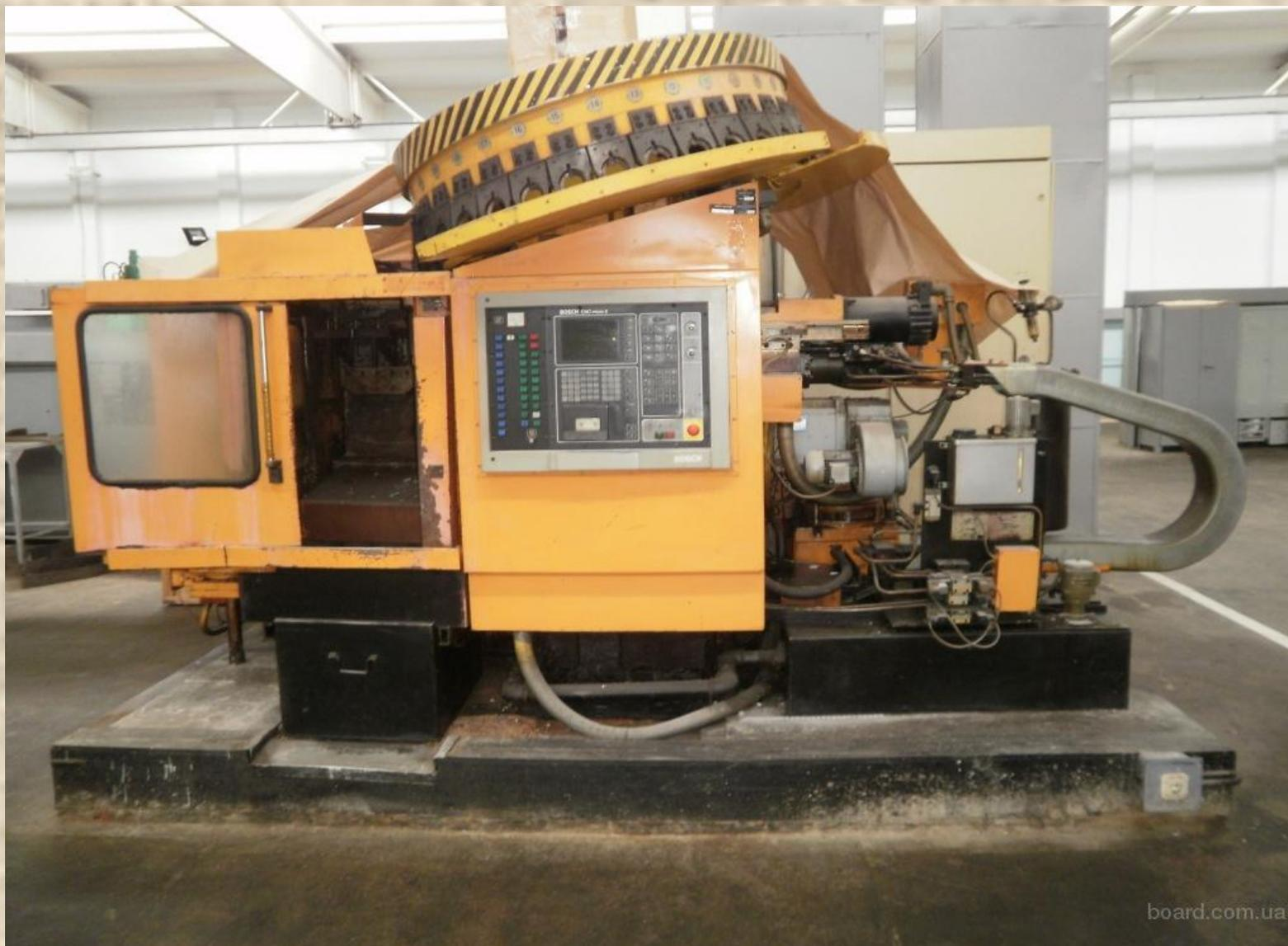
Многоцелевой сверлильно-фрезерно-расточный горизонтальный станок с подвижной стойкой, повышенной точности модели ИР320 предназначен для комплексной обработки корпусных деталей средних размеров с четырех сторон
