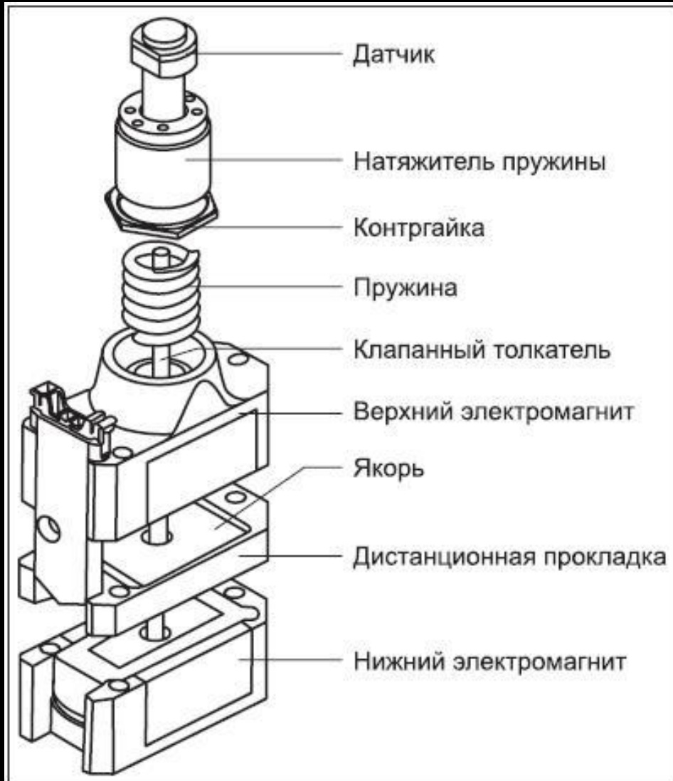
Рис. 3. Конструкция ЭМ клапана фирмы FEV-MT (ФРГ)
