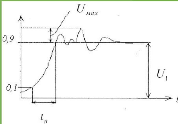
уровня выходного сигнала канала при подаче на его вход единичного ступенчатого воздействия. Неравномерность переходной характеристики:
