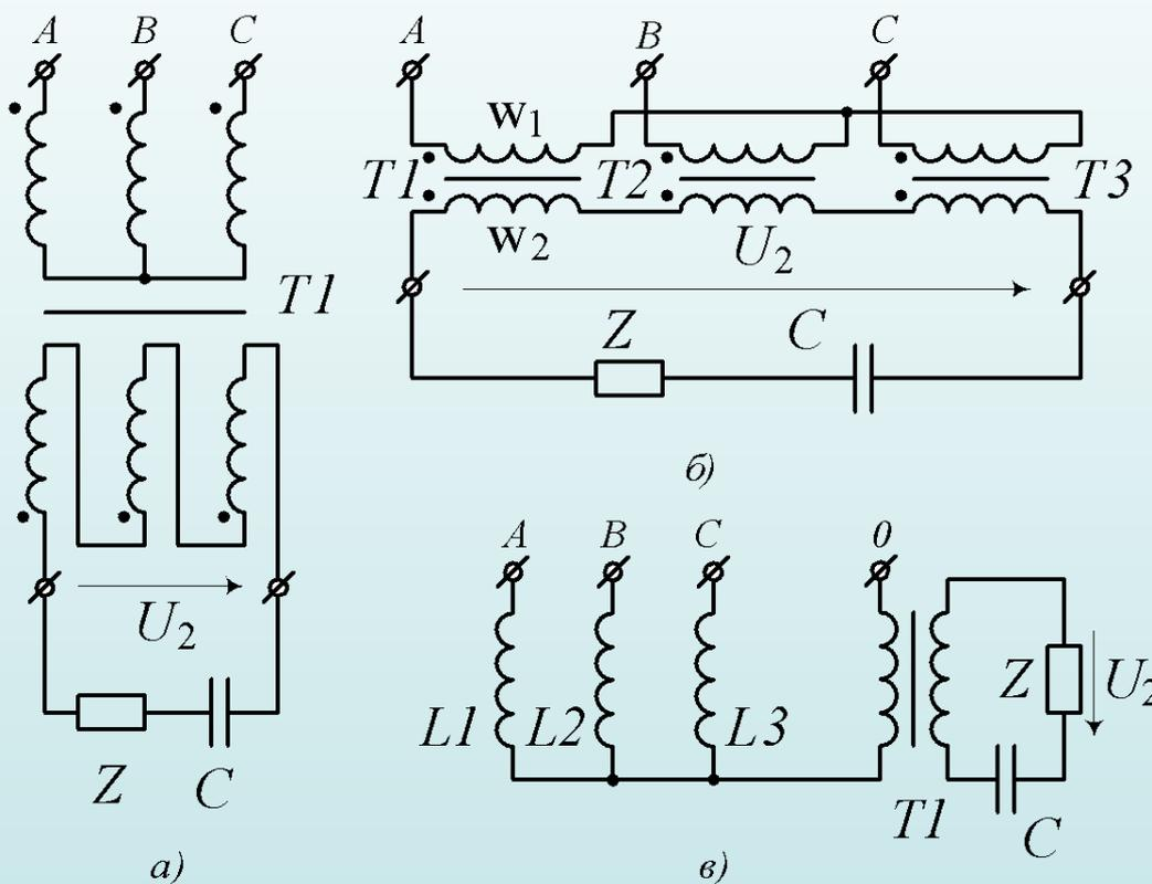
Принцип работы преобразователей для утроения частоты питающего напряжения на нагрузке, выполненных на базе трансформаторов, основан на использовании третьей гармоники, возникающей при насыщении сердечников трансформаторов, подключённых к трёхфазной сети.
