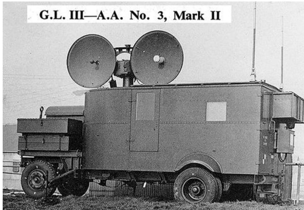
Станция орудийной наводки GL-Mk-III
