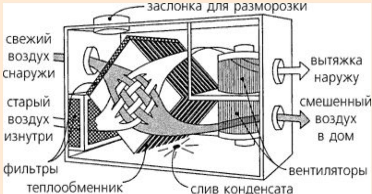
Пластинчатый рекуператор тепла для системы с принудительной вентиляцией.
