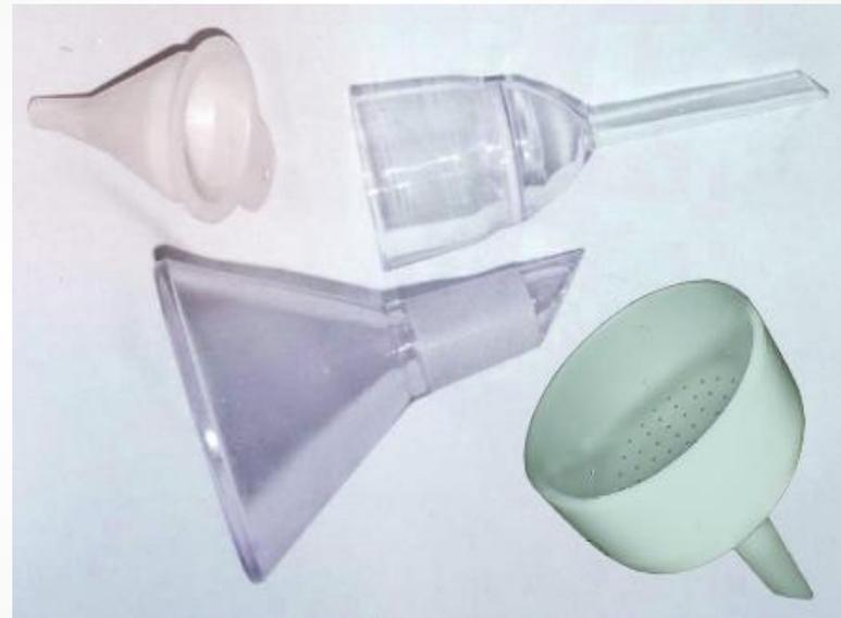
Воронки используют для переливания жидкостей, для фильтрования, пересыпания сыпучих веществ
