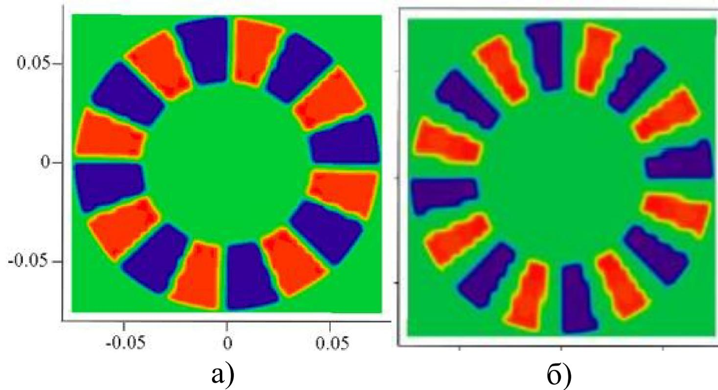
Рис.4. Распределение зарядов для случая массы магнитов 47.1 гр. (а)
