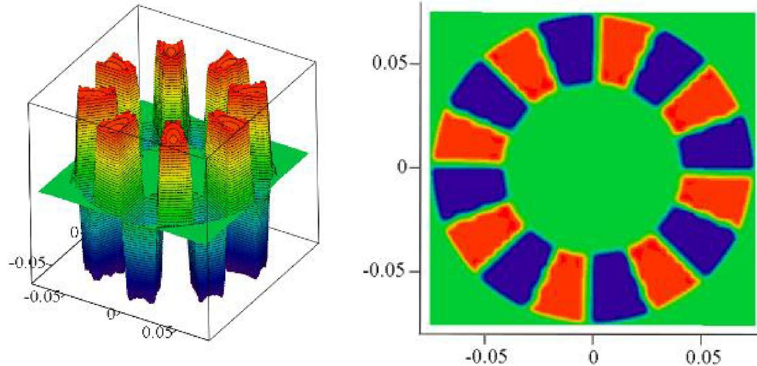
Рис.2. Распределение плотности фиктивных магнитных зарядов по поверхности магнитных дисков ротора.
