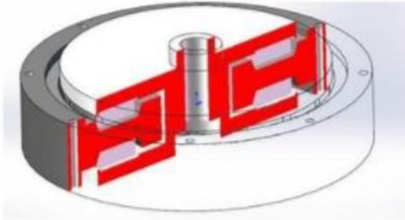
Рис.1. 3D модель генератора осевого потока с постоянными магнитами.
