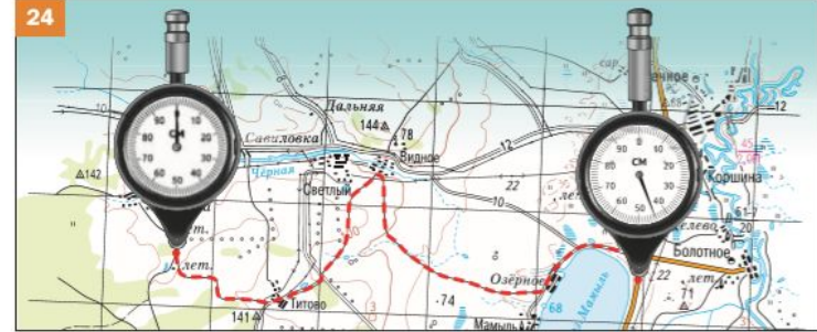
Измерение расстояния курвиметром
