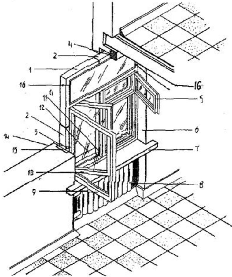
1 – оконная коробка; 2 – гидроизоляция; 3 – конопатка; 4 – ж.б. перемычка; 5 – форточка; 6 – оконный откос; 7 – подоконная доска; 8 – ниша подоконно отопительного прибора; 9 – створка подоконного переплета; 10 – ветроостанов; 11 – шпингалет; 12 – подоконный наружный слив; 13 – деревянная пробка в стене для крепления коробок; 14 – оконная четверть; 15 – штанга фрамуги; 16 – фрамуга.
