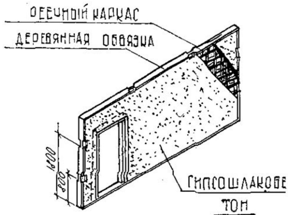
Гипсоопилочная перегородка: а — конструкция перегородки с проемом; б — деталь установки междокомнатной перегородки; в — то же, межквартирной; 1 — чалочные стропы; 2 — рейки деревянные сечением 25×10 мм; 3 — железобетонная плита перекрытия; 4 — заделка гипсобетонная; 5 — петля чалочной стропы после сплющивания; 6 — панельная перегородка; 7 — плинтус; 8 — звукоизоляционная прокладка; 9 — выравнивающий слой; 10 — пол; 11 —
