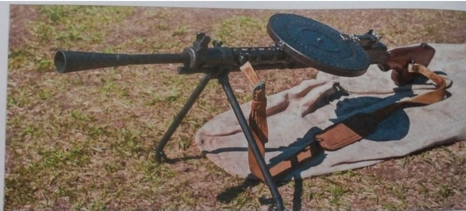
Для придания дополнительной устойчивости пулемету при стрельбе на кожух ствола крепили сошки, которые в походном положении складывались.
