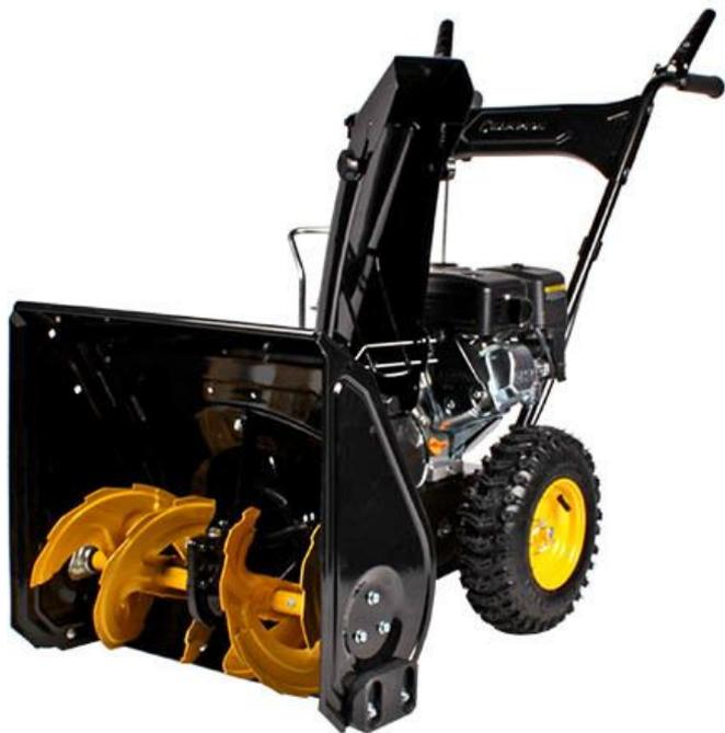
CHAMPION ST553 — бензиновый самоходный снегоуборщик для очистки от снега подъездных дорожек и придомовой территории. Модель оснащена 4-тактным двигателем мощностью 5,5 л.с. Имеет 4 скорости. Запуск осуществляется ручным стартером. Максимальная дальность выброса собранного снега — 8 м. Аппарат справляется со снежным покровом высотой до 51 см. Ширина захвата — 53 см.
