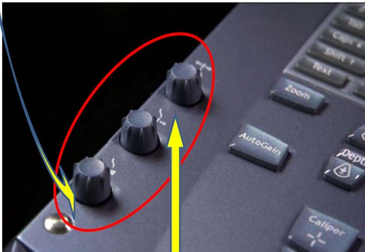
**Регуляторы временной компенсации усиления (time gain compensation, TGC)** ультразвукового аппарата позволяют оператору настроить усиление на различной глубине.
