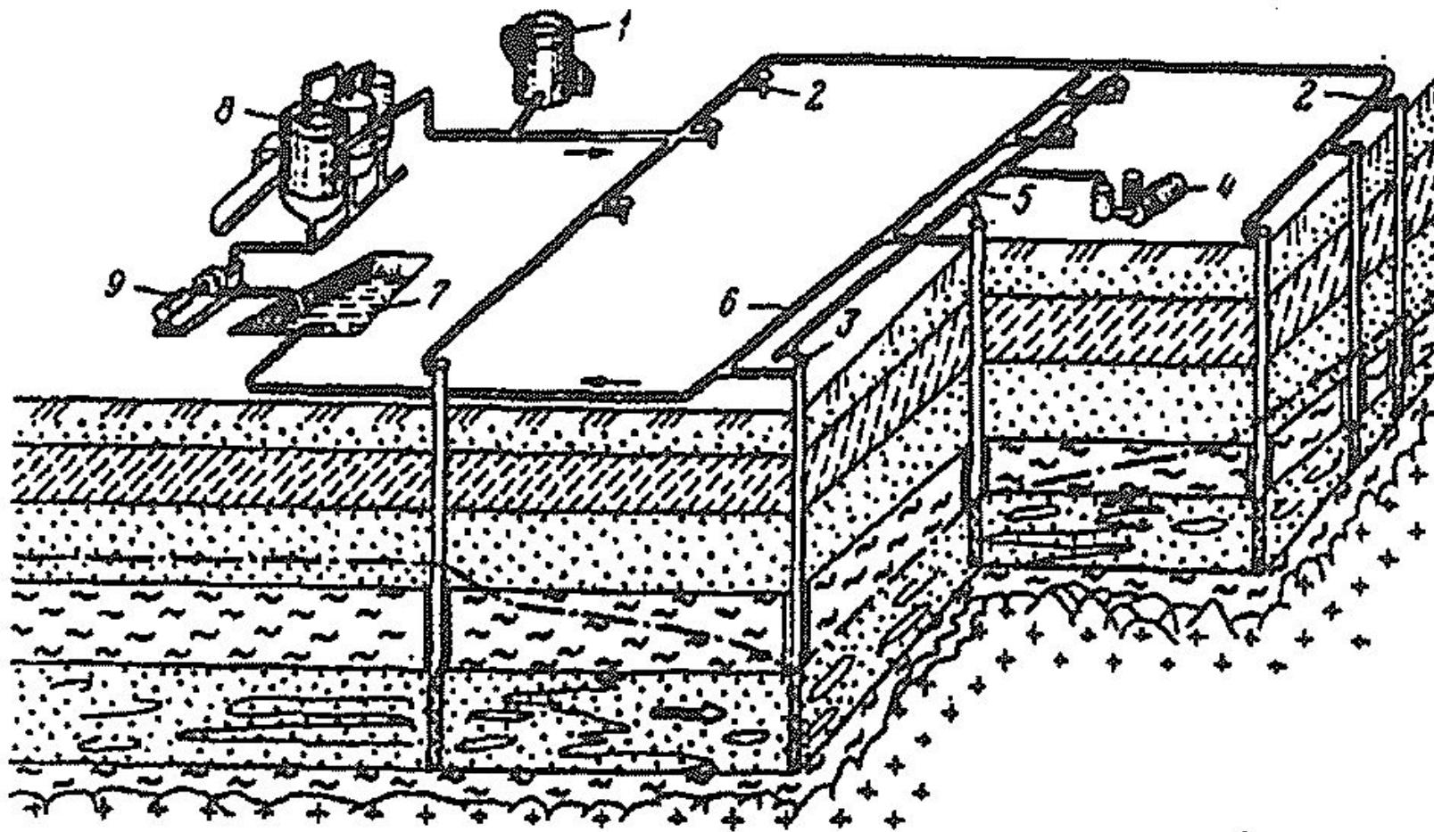
**Рис. 14.1. Схема отработки пластового месторождения выщелачиванием через скважины:**
