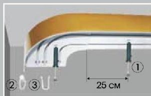
1. Разметить и просверлить отверстия в пластиковом профиле и потолке. Шаг отверстий от торца профиля - 25 см, далее 50-70 см в зависимости от размера карниза.
