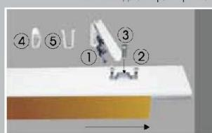
1. Разметить и просверлить отверстия для кронштейнов в стене на желаемой высоте, вставить дюбели. Прикрепить кронштейны к стене шурупами (1).
