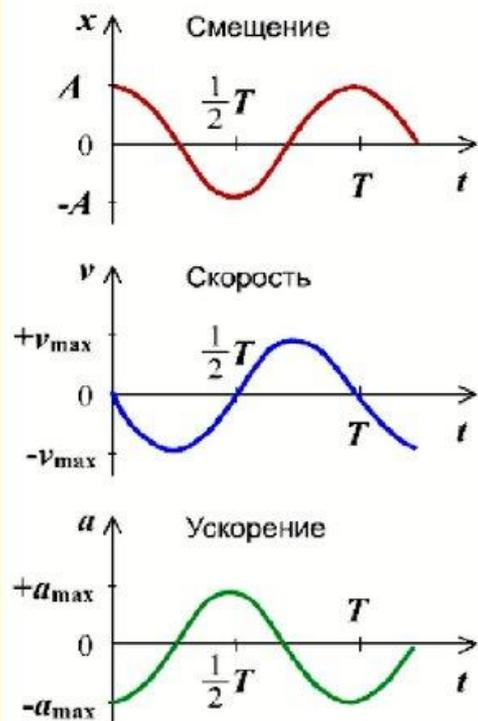
Графики смещения, скорости, ускорения при гармонических колебаниях
