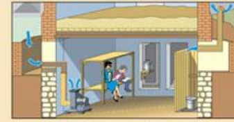
Подвал одноэтажного здания, приспособленный под противорадиационное укрытие
