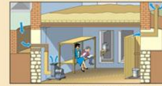
Подвал одноэтажного здания, приспособленный под противорадиационное укрытие
