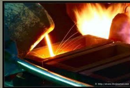
Поступающие для плавки частицы одного или нескольких металлов загружаются в специальные плавильные печи, под влиянием высокой температуры доводятся до жидкой однородной массы, которая отливается в формы для получения слитков. Материал, поступающий в плавку, называется шихтовым, или шихтой. Шихта может быть в виде чистых металлов, бракованных слитков и изделий, лома, обрезков, стружки и опилок и других отходов ювелирного производства.
