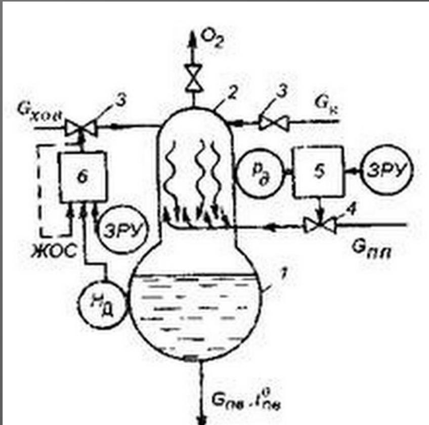
Для непрерывного нагрева и удаления кислорода из воды в деаэраторе поддерживается избыточное давление пара  $p_d$ , соответствующая ему температура насыщения  $t_d = t_{п.в}$  и уровень  $H_d$ .
