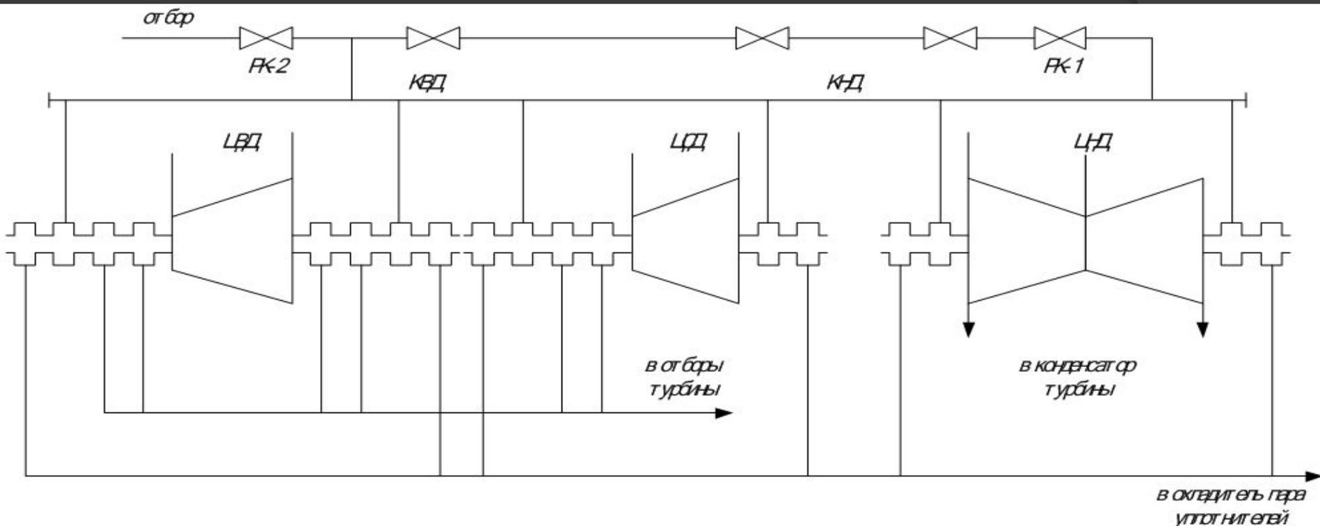
При пуске турбины из холодного состояния в КНД подается пар от общестанционного коллектора собственных нужд (КСН), КВД соединяется с КНД, пар подается на все уплотнения турбины и регулятор давления РД-1 поддерживает давление в коллекторах (в камерах уплотнений) на заданном значении, воздействуя на клапан РК-1 подвода пара к КНД. В этом режиме возможен также сброс избытка пара из КВД через клапан РК-2 в ПНД № 2.
