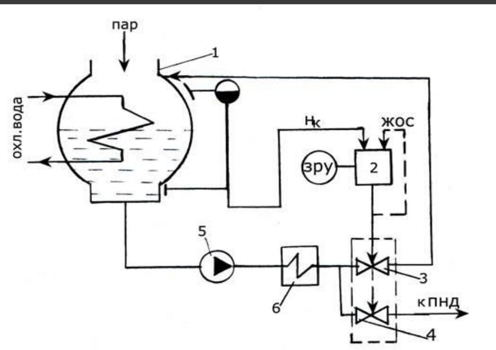
Как объект управления конденсатор 1 представляет собой герметичный бак с насосом на стоке и не обладает свойством самовыравниванию уровня. Регулирование уровня воды осуществляется изменением расхода конденсата после насоса 5 путем воздействия на двух потоковый клапан 3-4.
