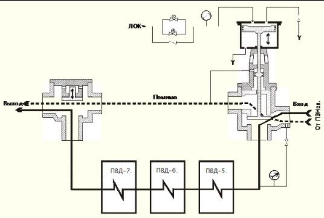
Подача воды производится открытием электрифицированной арматуры на трубопроводе от линии основного конденсата, от сигнала до повышения уровня до I-го предела. Конструкция впускного клапана выполнена так, что при закрытии канала подачи воды в ПВД-5 открываются два обводных канала и сразу закрывается обратный клапан и поток идет мимо.
