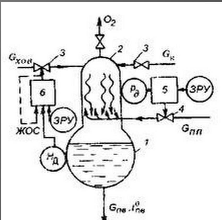
При параллельной работе группы деаэраторов регулятор давления и регулятор уровня воздействуют на соответствующие регулирующие клапаны на линиях общего подвода пара и химически очищенной воды.
