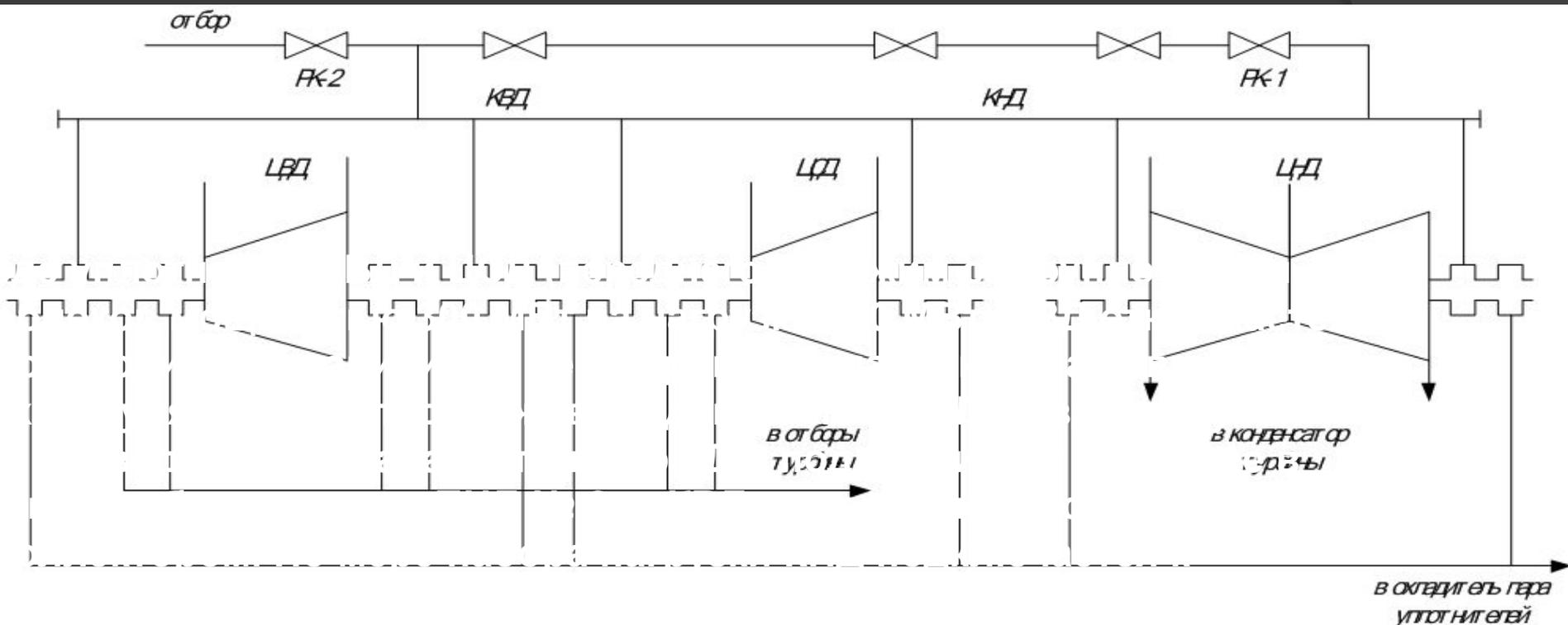
При переходе уплотнений ЦВД и ЦСД (переднего) в режим самоуплотнения (для энергоблоков мощностью 300 МВт на нагрузке 150 МВт) КВД отключается от КНД и производится независимое регулирование давления пара в коллекторах: регулятор РД-1 поддерживает давление в КНД, воздействуя на клапан РК-1 подвода к нему пара; регулятор РД-2 поддерживает давление в КВД, сбрасывая избыток пара в ПНД № 2, и КВД в этом режиме становится отсосным коллектором. По мере набора нагрузки КНД подключается к деаэратору
