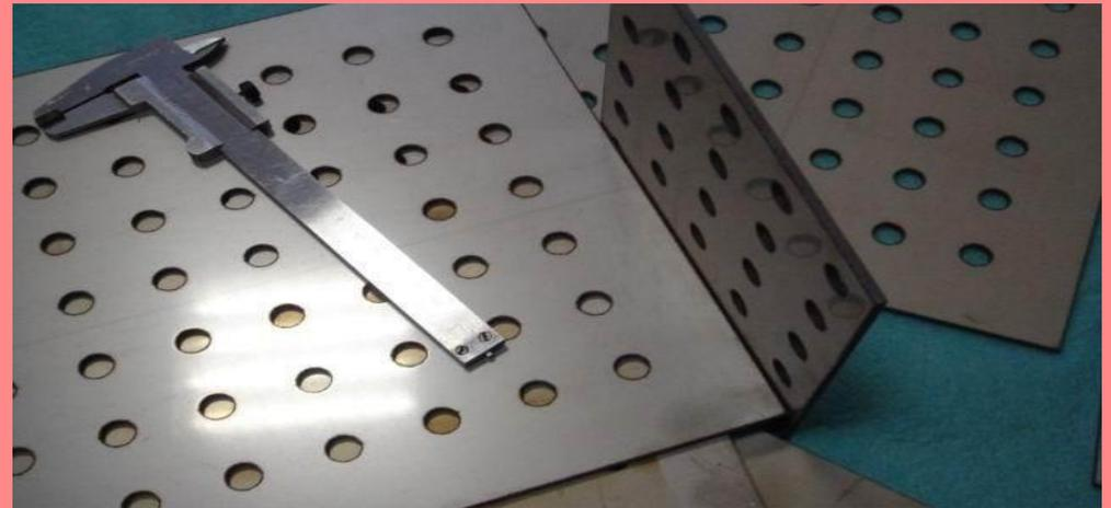
Листовую сталь выпускают толщиной до 60 мм; тонколистовую кровельную и оцинкованную сталь – толщиной 0,4 – 0,8. Листовая сталь может изготавливаться плоской, волнистой и с рифленой поверхностью.
