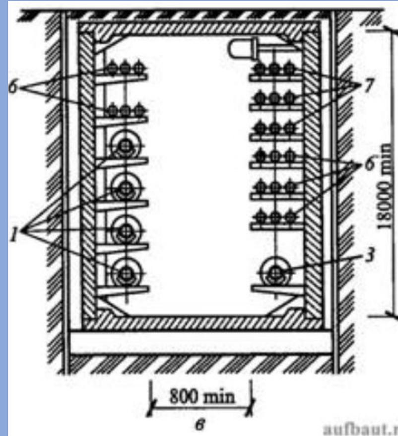
а- совмещенным способом; в-в совмещенном коллекторе; 1- теплосеть; 2- газопровод; 3- водопровод; 4 - водосток; 5 - канализация; 6 - кабели связи; 7-силовые кабели
