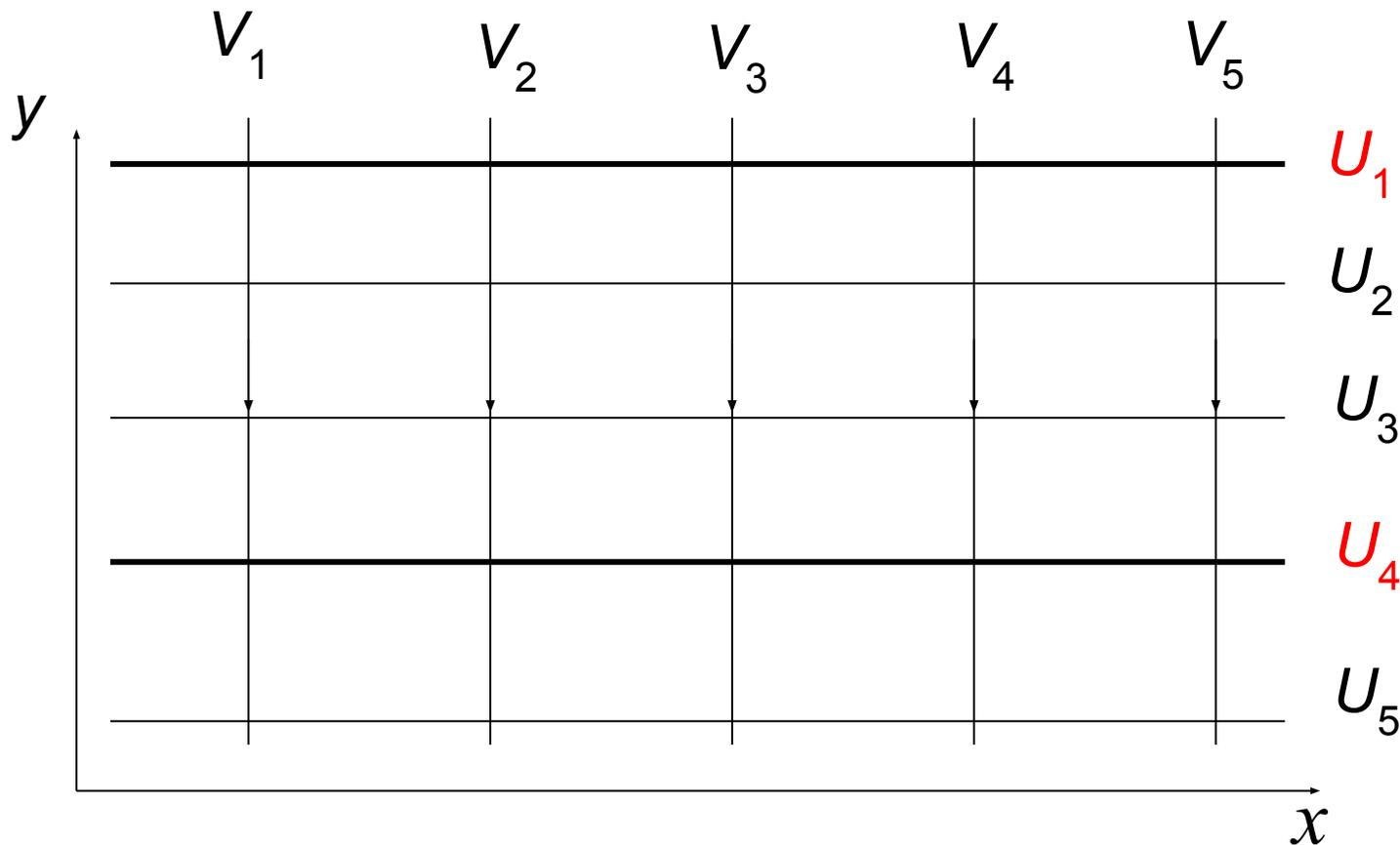
Совместив поверхности двух проводников с двумя линиями равного потенциала ( $U_1$  и  $U_4$ ), получаем картину поля между двумя плоскими проводящими пластинами (внутри плоского конденсатора). Таким образом, мы установили, какой геометрической области соответствует принятый комплексный потенциал.
