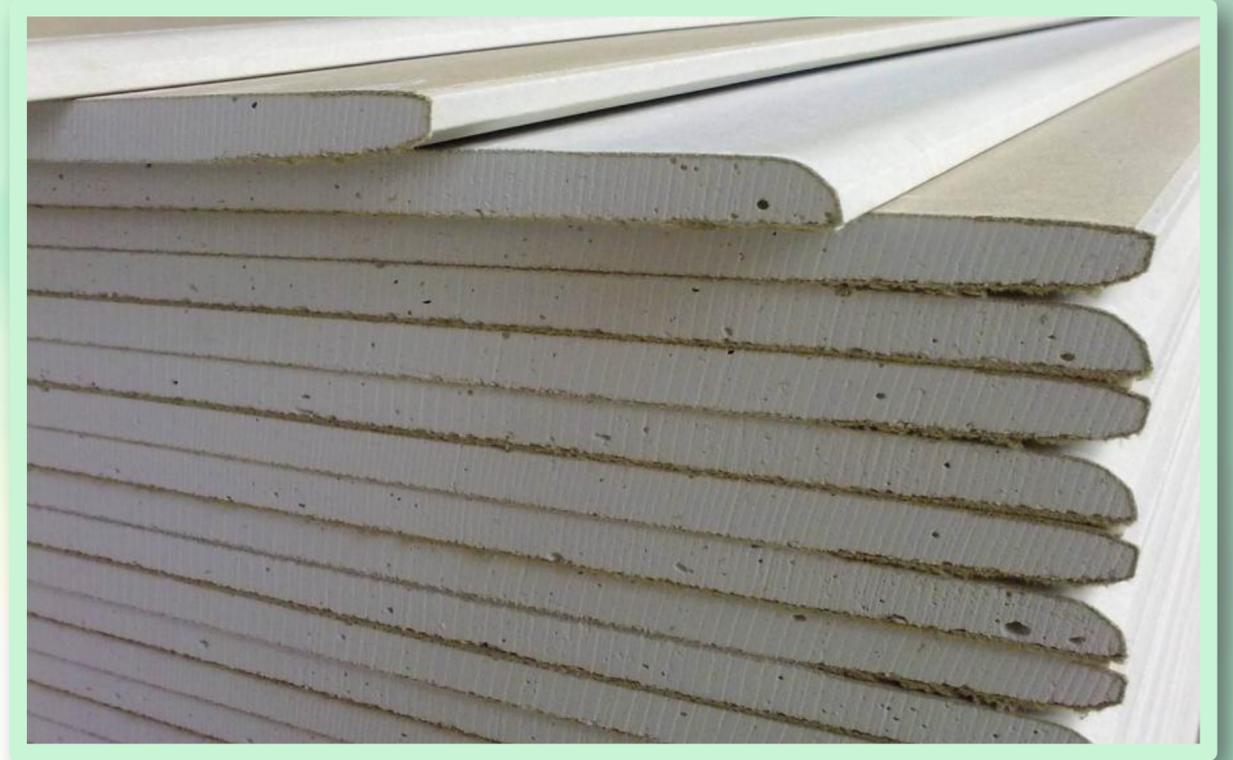
**Гипсокартон** - строительный материал, представляющий собой лист, состоящий из двух слоёв строительной бумаги (картон) и сердцевины из слоя твёрдого гипсового теста с наполнителями.
