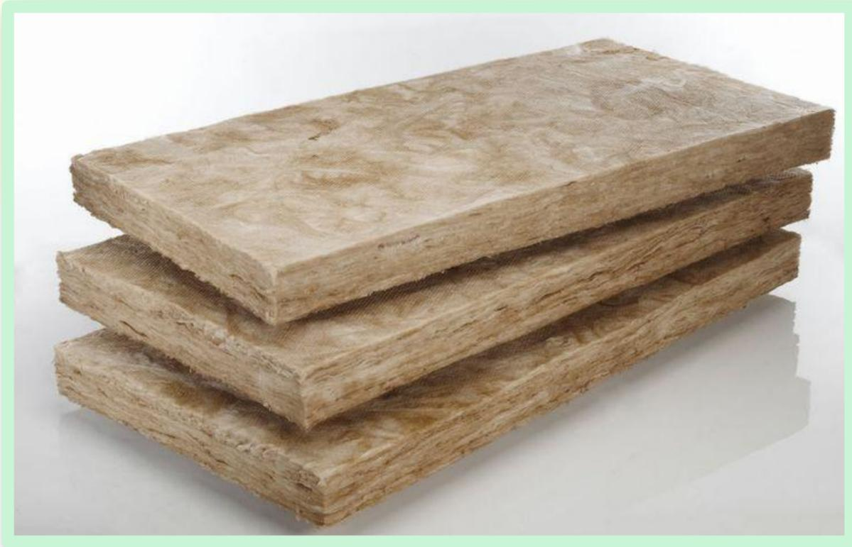
**Каменная вата** - тепло- звукоизоляция, изготовленная из расплава изверженных горных пород. Исходным сырьем для производства волокна каменной ваты служат габбро-базальтовые горные породы.
