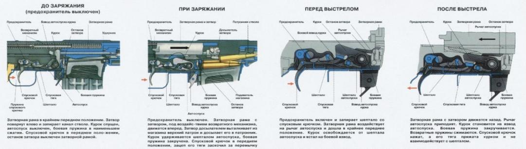
Затворная рама в крайнем переднем положении. Затвор повернут влево и заперт камбал стволь. Курок спущен, автопосуд выключен. Боевая пружина в нормальном состоянии. Спусковой крючок в переднем положении, ось боевой пружины выключена затворной рамой.
