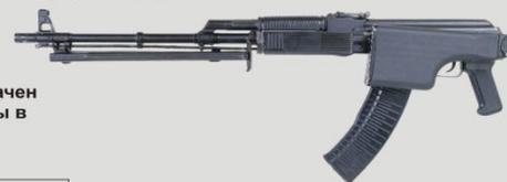
Ручной пулемет РПК-74М является оружием мотострелкового отделения. Он предназначен для уничтожения живой силы и поражения огневых средств противника. Для стрельбы в условиях естественной ночной освещенности может присоединяться прицел НСПУМ.
