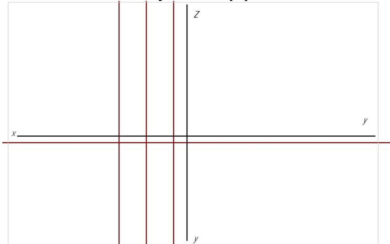
От вспомогательной прямой проведем еще две прямые на расстоянии в 20 мм
