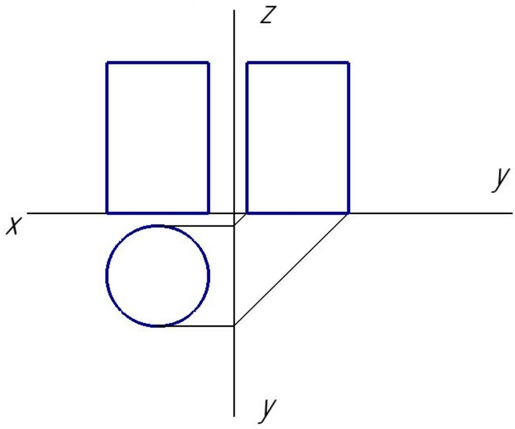
Достраиваем в профильной плоскости фигуру и удаляем вспомогательные прямые
