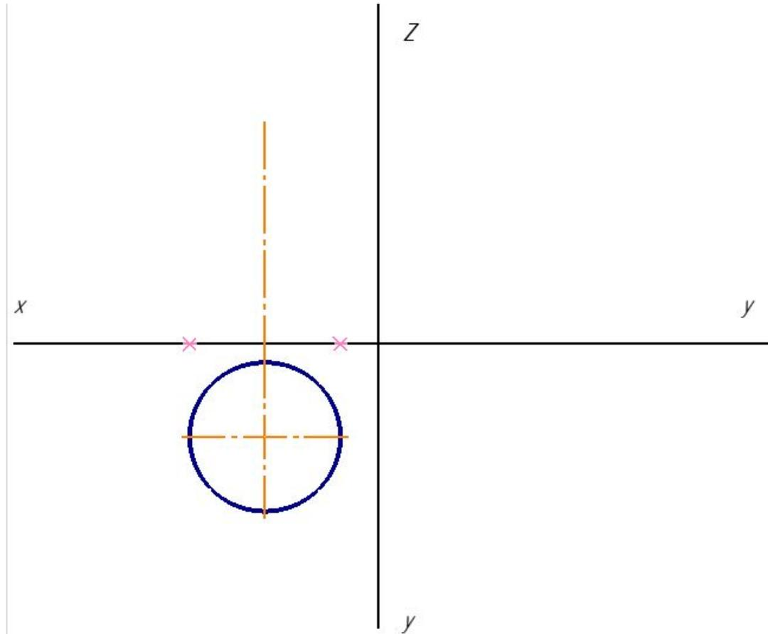
Продлите осевую линию над осью  $Ox$  на высоту 60 мм. От проведенной осевой линии отметим две точки на расстоянии радиуса – 20 мм.
