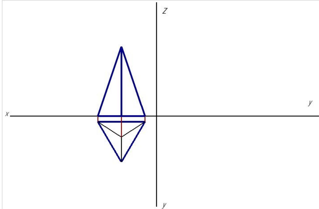
Поднимите от центра на оси OX высоту равную 60 мм и соедините ее вершину с двумя другими точками.
