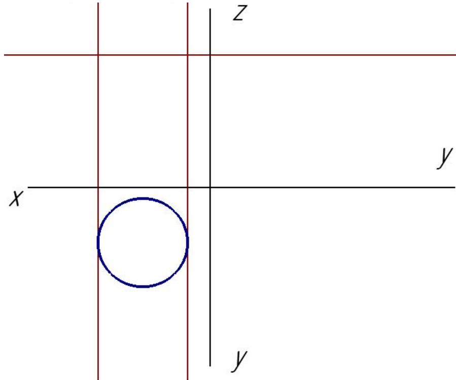
Строим две прямые параллельные оси ZY через грани окружности и проводим прямую параллельную оси XY на высоту равную 60 мм.
