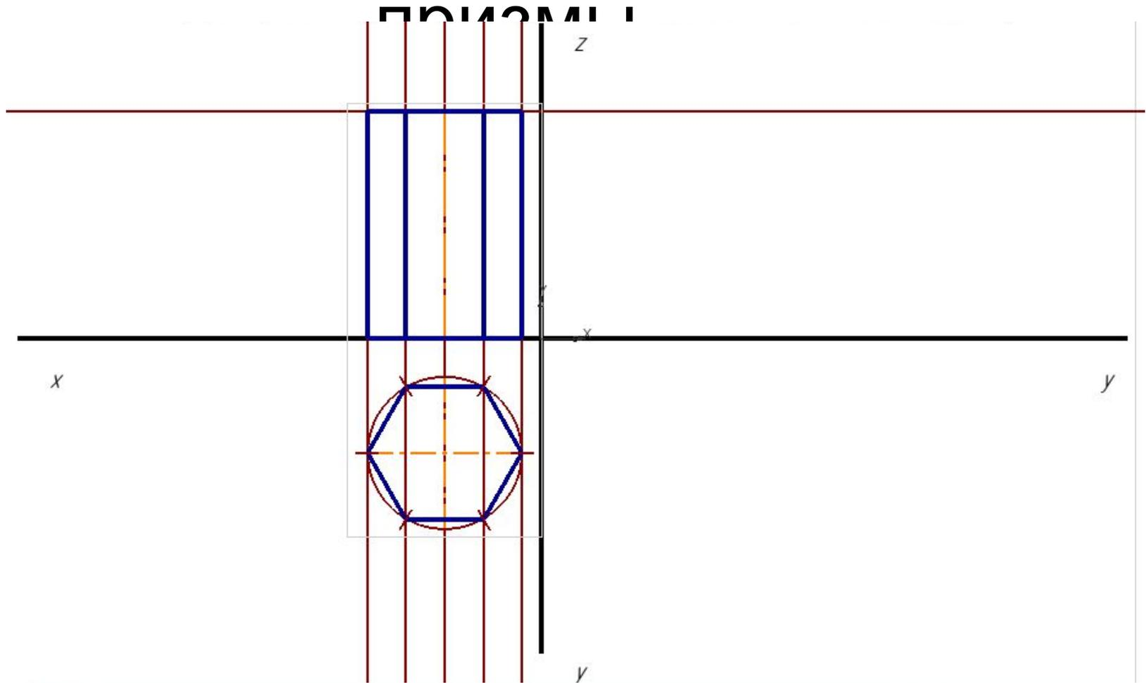
Провести вспомогательные прямые. И провести горизонтальную линию параллельно оси  $Ox$  на высоте 60 мм.
