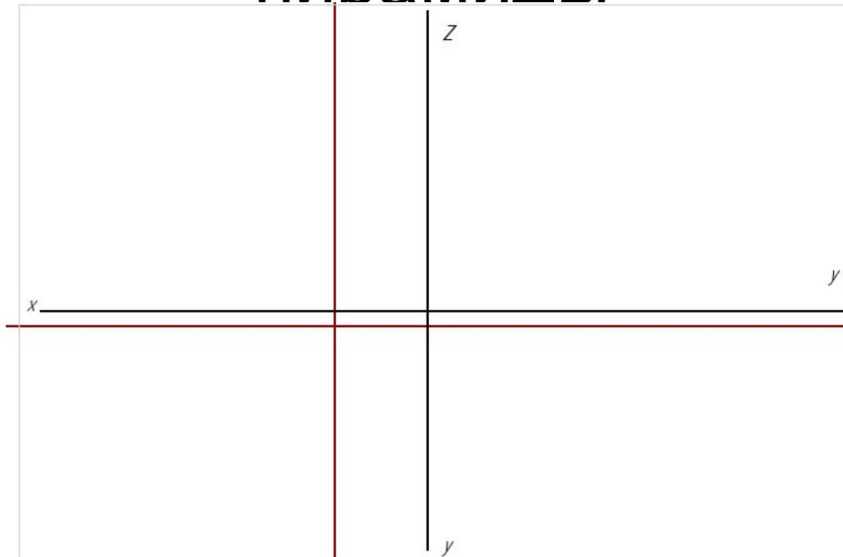
Проведем две вспомогательные прямые на расстоянии от оси  $Ox$  на 5 мм, от оси  $Oy$  на 30 мм.
