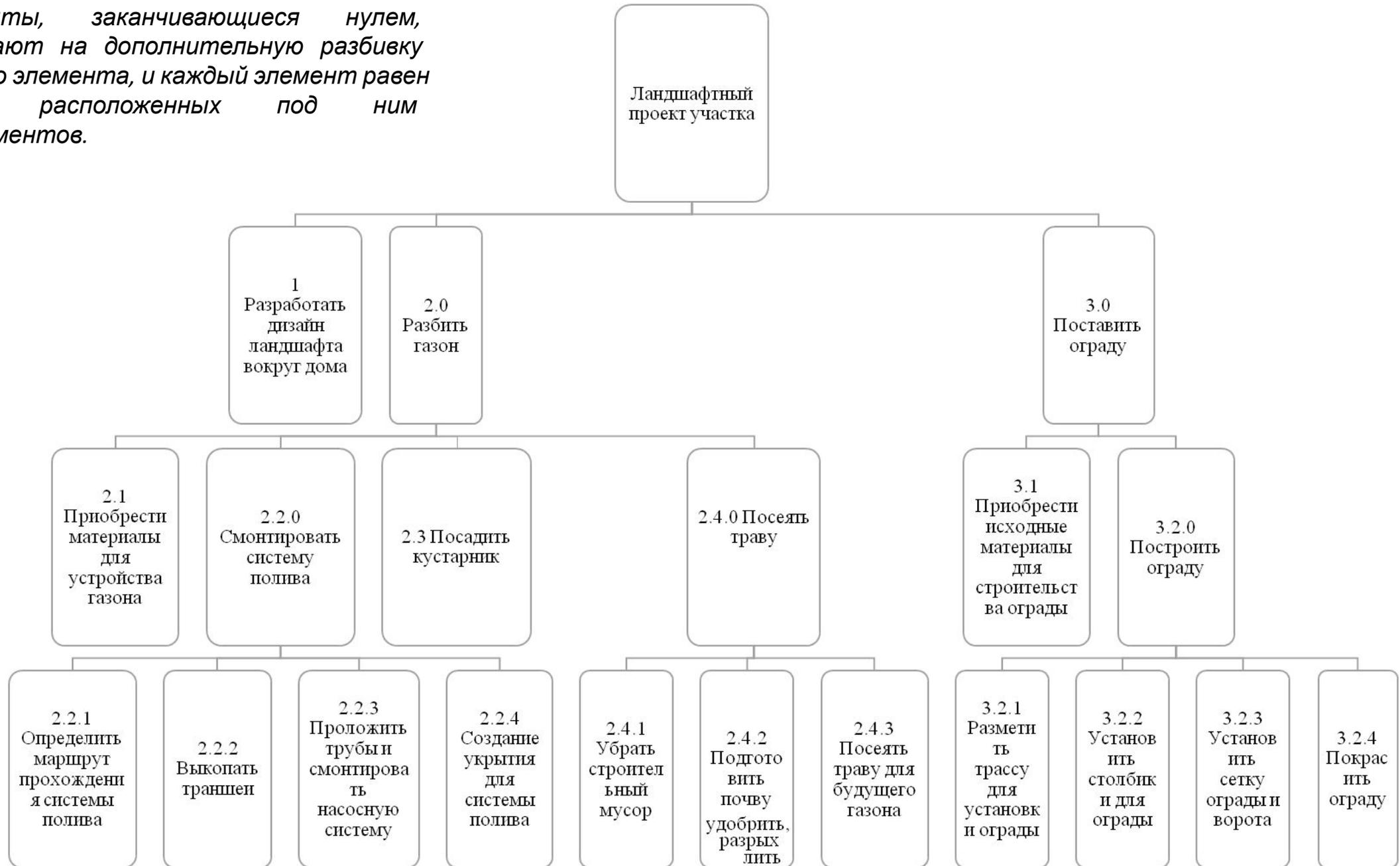
Схематическое представление декомпозиции работ, отражающее взаимное вложение работ:
