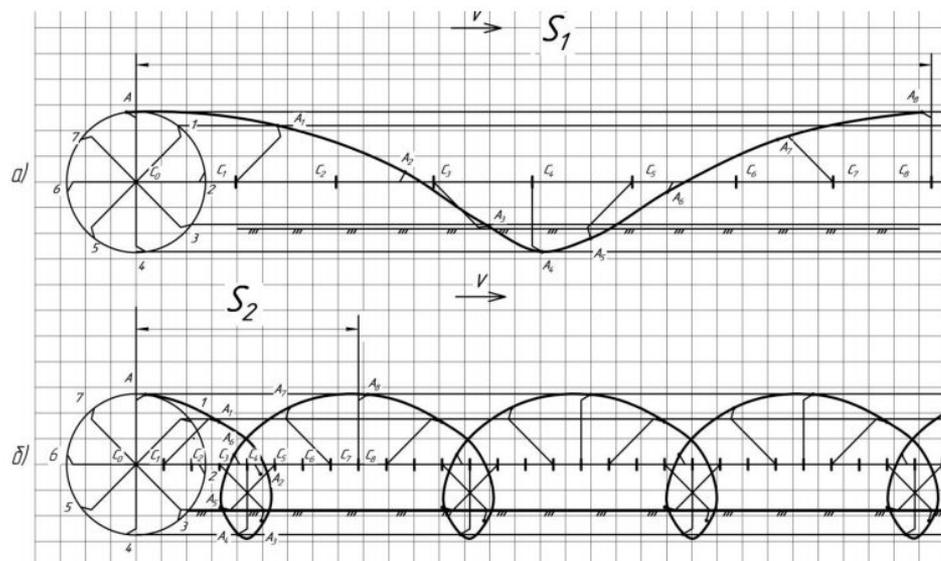
При работе автоприводного секционного рабочего органа передний ротор вращается с меньшей окружной скоростью, чем задний. Отношение скоростей: окружной конца ножа к скорости движения агрегата – для переднего ротора:  $\lambda_1 = \frac{u_1}{v} \leq 1$ , а заднего  $\lambda_2 = \frac{u_2}{v} \geq 1$  [1, 15]. Отсюда выражение  $\lambda$  для соотношения скоростей роторов:  $\lambda_1 \leq 1 \leq \lambda_2$ . Это соотношение может быть получено при некоторых конкретных условиях.
