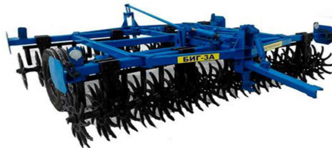
Борона игольчатая гидрофицированная БИГ-3А
